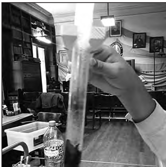
Tubo de ensayo con manteca luego del fuego directo.
